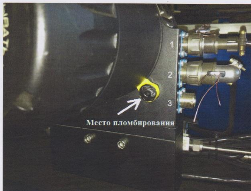
Рисунок 3 - Схема пломбирования блоков электроники БЭР Model 28 (восьмиканальный), Model 24 (четырёхканальный), Model 22 (двухканальный) и БЭР-ВР (вычислитель (корректор) расхода) КИУ «Вымпел-500»
